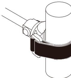
左側のバックルの付いた側のベルクロだけを外し、引き絞って対象パイプにぴったり合うように調整してから重ね合わせて止めます。
