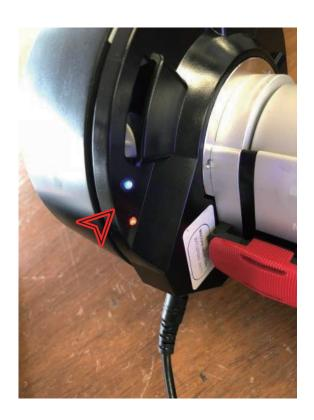
11. 通常起動時と同じように、赤が点灯、青が点滅していることを確認し、 あらためて、ANT+もしくは BLEでペアリングを行ってください。
