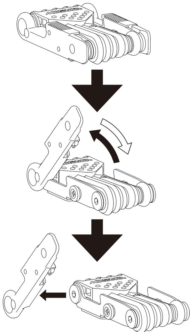
タイヤレバーは上に引き上げてから横にずらして外す。装着する際は、まず尾部の突起を軸ボルトの六角穴に収めてからスライドさせて装着する。
