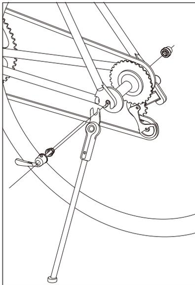
左側チェーンステーの外側に、後輪用クイックリリースと共締めして取り付けます。
