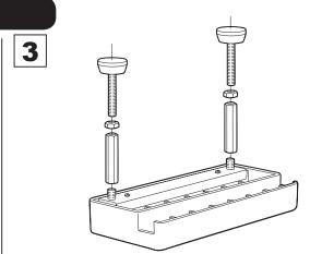
突き出た M8 ボルトのネジ部分にロングナットをねじ 込み、その上にアジャスタをねじ込みます。
