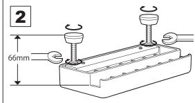
アジャスタの長さを合わせたあと、13mm スパナで ロックナットをステップ側に締め付けて固定します。
