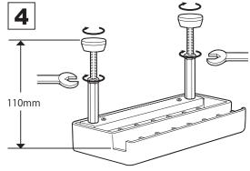
まず 13mm スパナでロングナットを板金具側にしっか りとねじ込み固定します。
