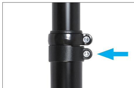
下側のボルトを3N.mで締め付けます。その後はバイクタワー・ピットの説明書にしたがって支柱の長さを決め、上側のボルトも3N.mで締め付けて固定します。
