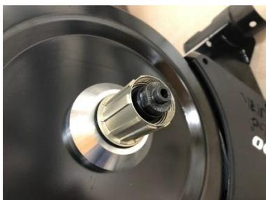
Step-02 : 17 ミリスパナもしくはモンキーレンチでサイズを合わせ、ロックナットを外す（緩める方向：フリーボディに正対して、反時計回り/左回り）
